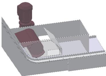
*permanent magnetischer Rutschförderer mit Trichter
